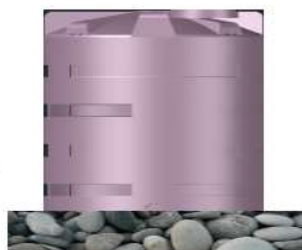
Terreno pedregoso o irregular y sin base estabilizada.
