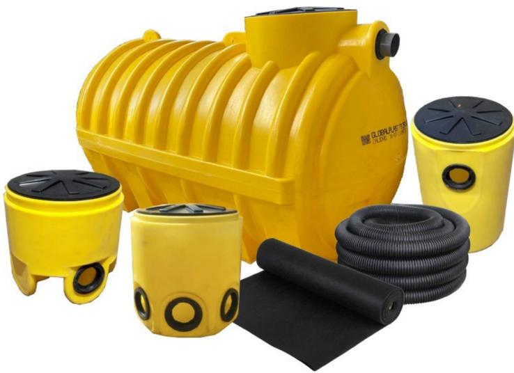
Instalar en terreno plano. Llenar a un 75% con agua al momento de cubrir el cuerpo de la fosa con 20 Cm de arena y se debe hacer radier de 10 Cm de espesor sobre el cuerpo total de la fosa.
